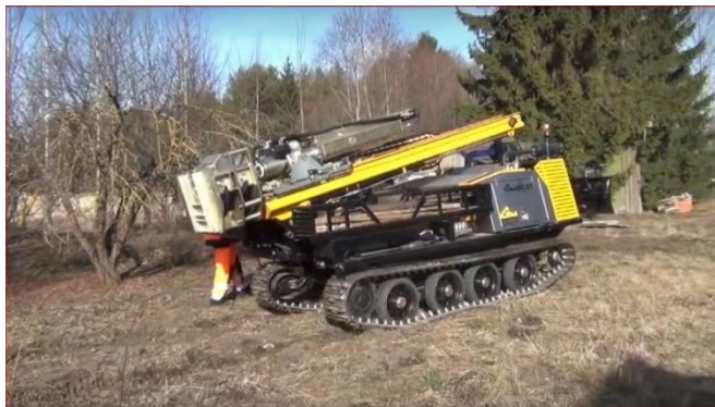
Pilt 1. Roomikutega või analoogne puurmasin
